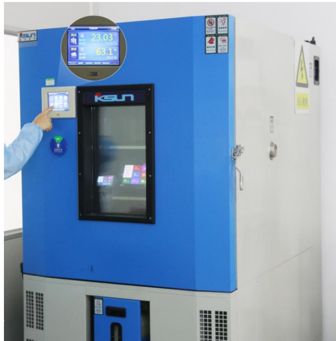
图 4-7 高低温老化测试图
